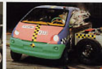
Crash-test latéral avec mannequin - 2000.
