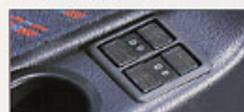
Commande de vitres électriques.
