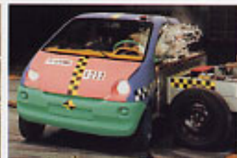
Crash-test latéral avec mannequin - 2000.
