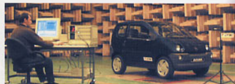
Test en chambre anéchoïque
